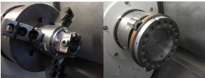
neu angefertigter Kupplungsaustrückmechanismus
