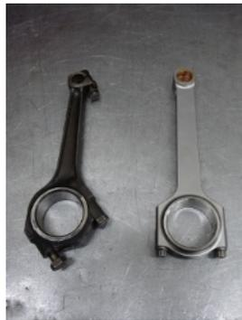
nach Kurbelwellenbruch, wurde eine neue, verstärkte konstruiert
