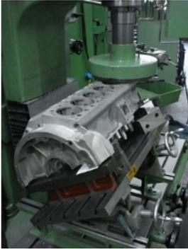
Block nach der Zylinderbüchsenitznachbearbeitung und bei Montage des Kurbeltriebes
