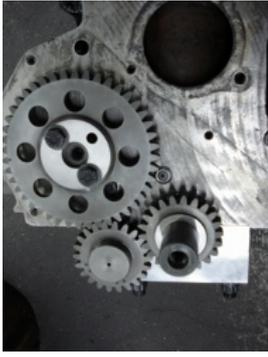
ausgelegter Kurbeltrieb, Motor bei Endmontage
