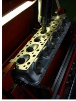
Block auf Bohrwerk beim Deck bearbeiten für den Zylinderbüchsenvorstand
