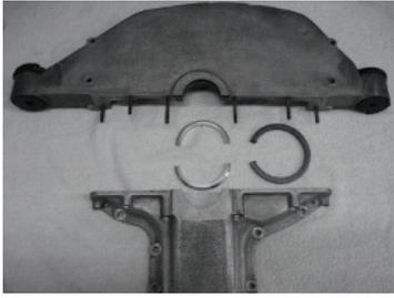
Anlauffläche für Axiallager wurde aufgetragen und nachgearbeitet, Moderne 3-Stofflagerschalen wurden eingepasst
