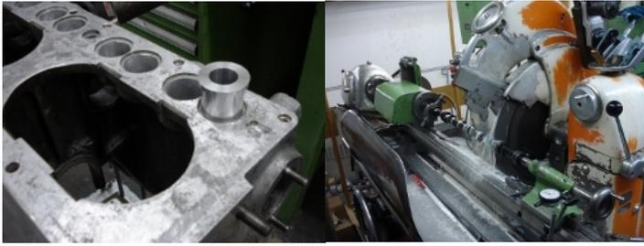
neuer Ölpumpendeckel im Fertigungsprozess, Vergleich zwischen alten und neuen Zahnradern, Pumpe vor der Montage und im Motor eingebaut
